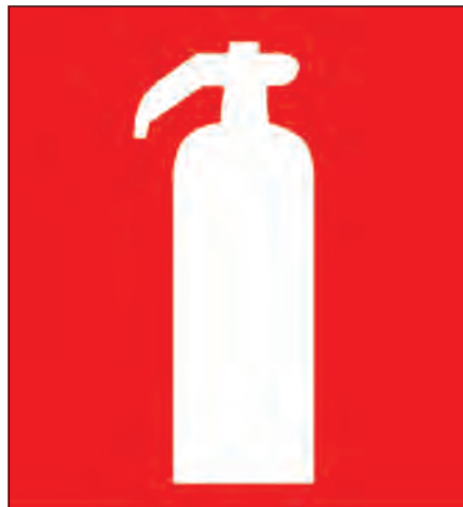
Figura 61: Sinalização de extintores
