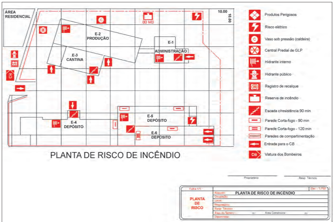
Figura 75: Planta de risco. Fonte: IT 01/11.
