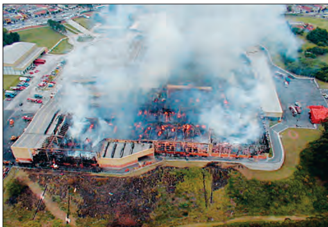
Figura 29: Propagação por radiação, convecção e condução
