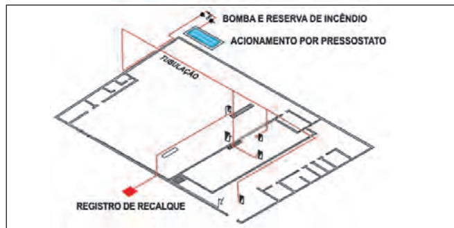
Figura 65: Perspectiva isométrica de sistema de hidrantes
