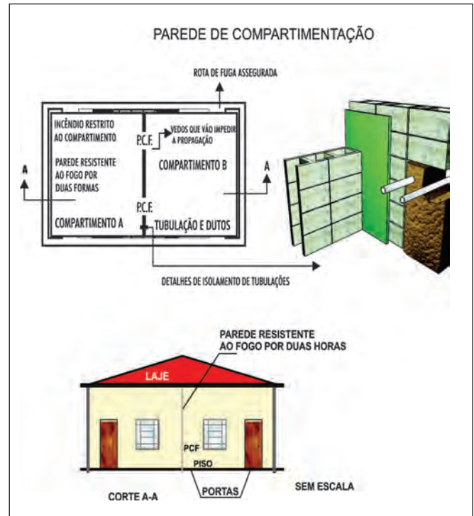
Figura 32: Detalhes de parede de compartimentação
