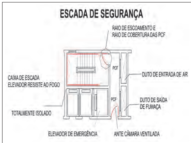
Figura 51: Escada e elevador à prova de fumaça
