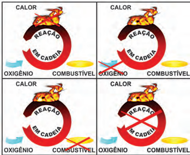
Figura 19: Formas de extinção do fogo
